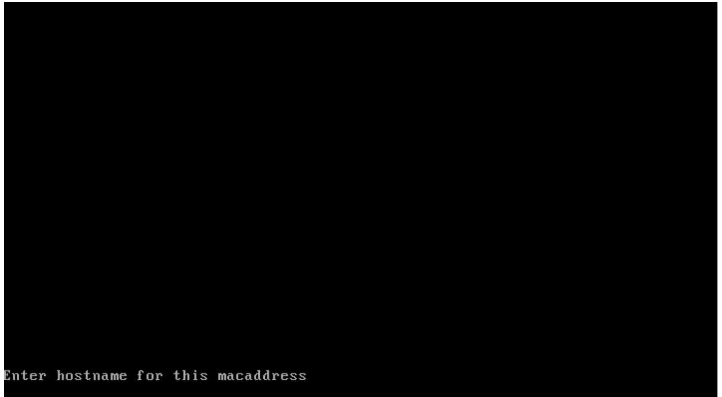
FIG. 22 – Fenêtre de terminal texte demandant un nom d’hôte lors de l’enregistrement à l’aide de la méthode WinPE
